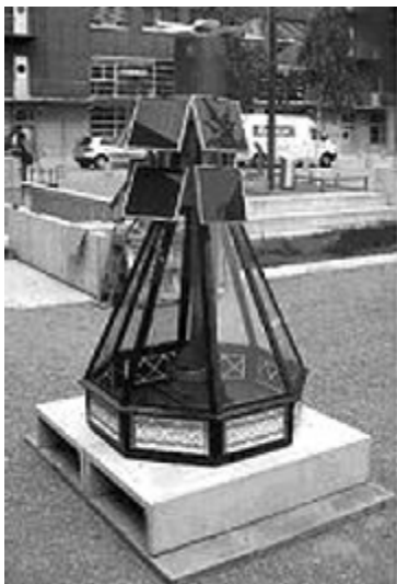
Рисунок 3 - Модель установки SCAF для очистки воздуха.
